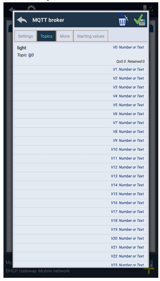
3.新增一個Switch元件,Server設定為第1步驟所建立的Server Name; Variable則設定為第2步驟所建立的名稱,light。Value for state:Switch ON設定為1; Value for state:Switch OFF設定為0。設定好之後,接下下方綠色的勾,這時,瀏覽器、手機以及micro:bit便可以互相溝通,並且可以用手機或瀏覽器控制電燈開或是關,便達到了控制家中電器的功能。
